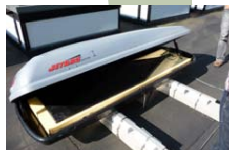
16. De detector is gereed voor gebruik. De zware betonstukken voorkomen wegwaaien.
