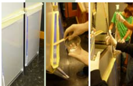
9. De lichtgeleider blijft zonder steun overeind staan en drukt de overtollige lijm weg die opgevangen wordt in de lijmgoten. Hierna volgt 48 uur 'droogtijd'. Daarna worden de sensoren lichtdicht ingepakt.
