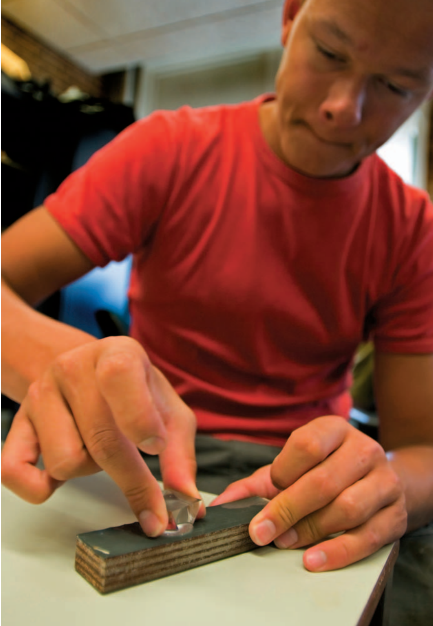
De lichtgeleider wordt door een leerling passend gemaakt.
