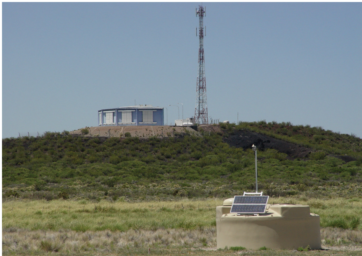
Figuur 1 De twee belangrijkste detectietechnieken van het Pierre Auger Observatorium. Op de voorgrond een watertank en op de heuvel een fluorescentiedetector met gesloten deuren. Het zonnepaneel op de watertank staat naar het noorden gericht. De antennes op de watertank en in de hoge mast naast het fluorescentiegebouw worden gebruikt voor de communicatie tussen watertanks en de fluorescentiedetector en met de centrale campus.
