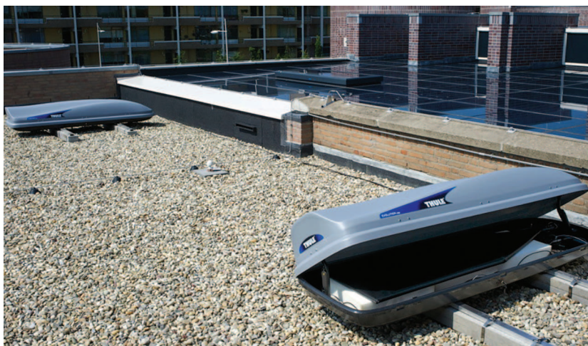
Figuur 2 Een skibox met daarin een scintillatiedetector van 100 cm x 50 cm met een dikte van 2 cm. De detector geeft een lichtpuls als een gamma-, elektrono of muondeeltje door de scintillator schiet. De hoeveelheid licht wordt als functie van de tijd gemeten.
