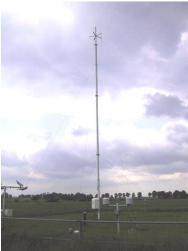
Figuur 3.5 De bliksem detectie meetopstelling van het KNMI. Bron: KNMI
