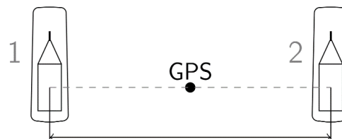
Figuur 4.18: De opstelling van station 2010. De afstand wordt gevarieerd: 40, 35, 30, 25, 20, 15, 10 en 5 meter.
