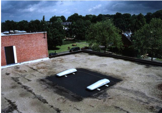
Figuur 3.27: Een HiSPARC detectiestation met twee scintillatoren (links); het lichtsignaal wordt omgezet in een elektrisch signaal dat vervolgens gedigitaliseerd wordt en van een tijdstempel voorzien (rechts).
