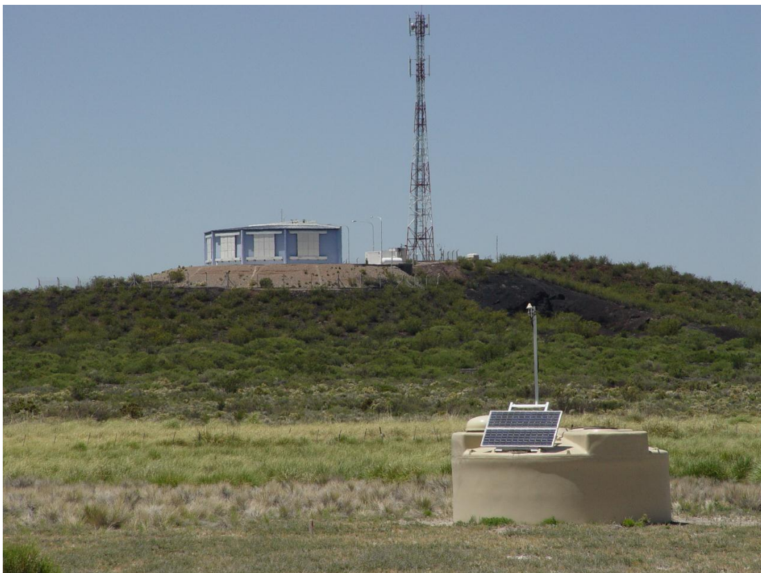
Figuur 2.2: Het Auger experiment. Op de voorgrond een van de ruim 1600 deeltjesdetectoren. In het gebouw op de achtergrond bevindt zich een fluorescentiedetector waarmee het lichtspoor van een deeltjeslawine gemeten wordt. Bron: de Auger collaboratie [12].
