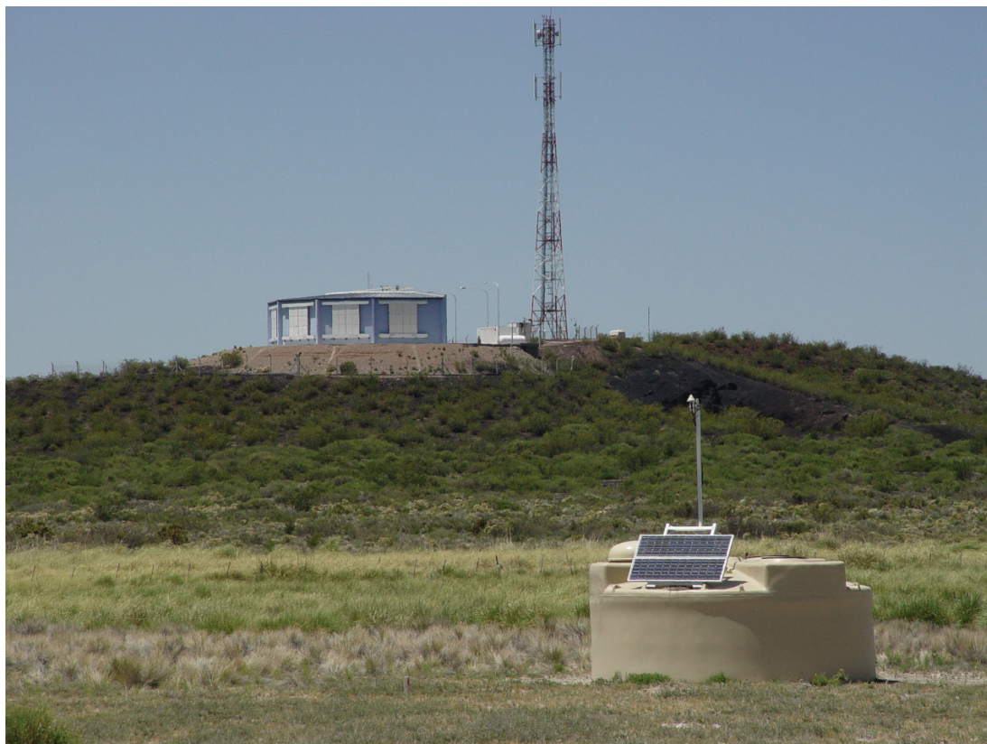
Figuur 2.2: Het Auger experiment. Op de voorgrond een van de ruim 1600 deeltjesdetectoren. In het gebouw op de achtergrond bevindt zich een fluorescentiedetector waarmee het lichtspoor van een deeltjeslawine gemeten wordt. Bron: de Auger collaboratie [11].
