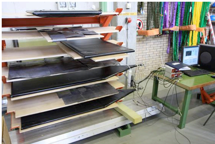
Figuur 3.71: Zijaanzicht van de opstelling met rechts de HiSPARC elektronica en data acquisitie PC.
