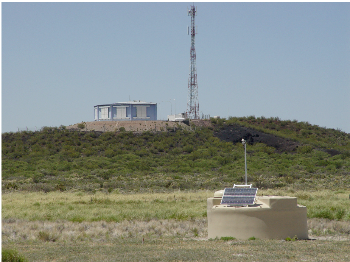
Figuur 2.2: Het Auger experiment. Op de voorgrond 1 van de ruim 1600 deeltjesdetectoren. In het gebouw op de achtergrond bevindt zich een fluorescentiedetector waarmee het lichtspoor van een deeltjes-lawine gemeten wordt. Bron: de Auger collaboratie [11].
