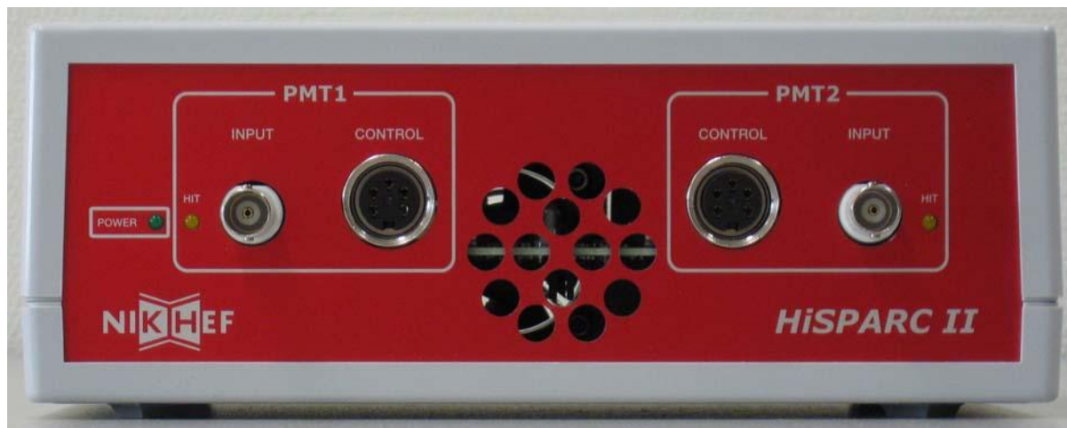
Figure 2.1: De voorkant van de HiSPARC II Master; van links naar rechts: groene LED voor de voedingsspanning, de gele LED geeft aan of er signalen binnenkomen, signaal- en voedingsaansluiting voor fotobuis-1. Midden: de inlaat voor de luchtkoeling. Rechts in omgekeerde volgorde: voedings- en signaalaansluiting fotobuis-2 en gele signaal LED.
