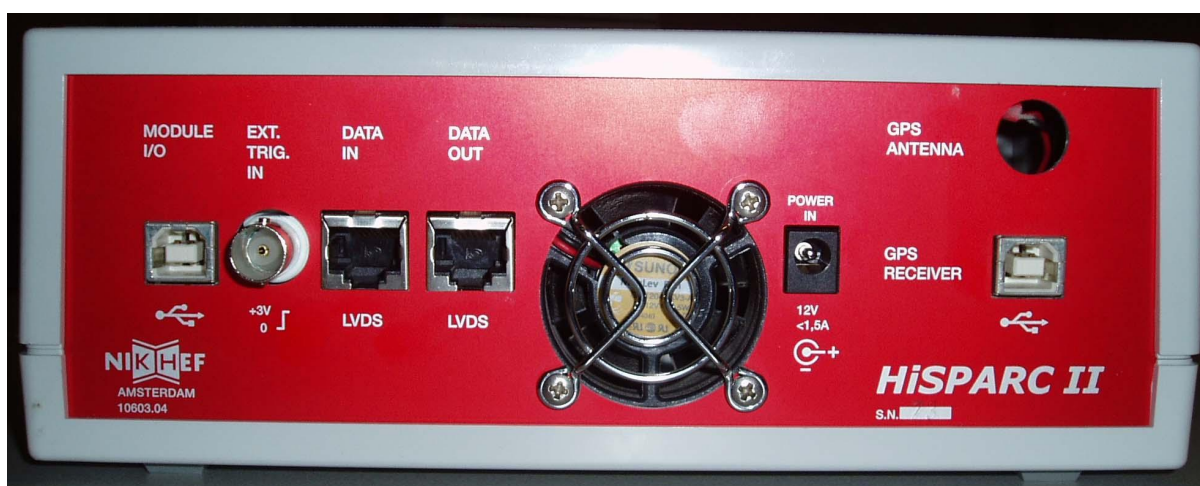
Figure 2.4: Data van de HiSPARC II Slave wordt uitgelezen via de linker USB verbinding. De Slave heeft geen aansluiting voor een GPS antenne kabel (rechtsboven); de rechter USB aansluiting is zonder functie.
