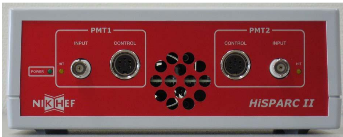
Figure 2.3: De voorkant van de HiSPARC II Master en Slave zijn identiek.
