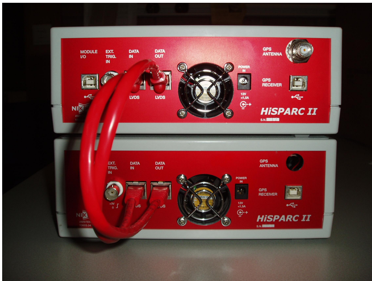
Figure 2.5: Een snelle databus verzorgt de communicatie tussen HiSPARC II Master en Slave; de verbinding bestaat uit twee kabels die 'LVDS data in' en 'LVDS data out' (kruislings) met elkaar verbinden.
