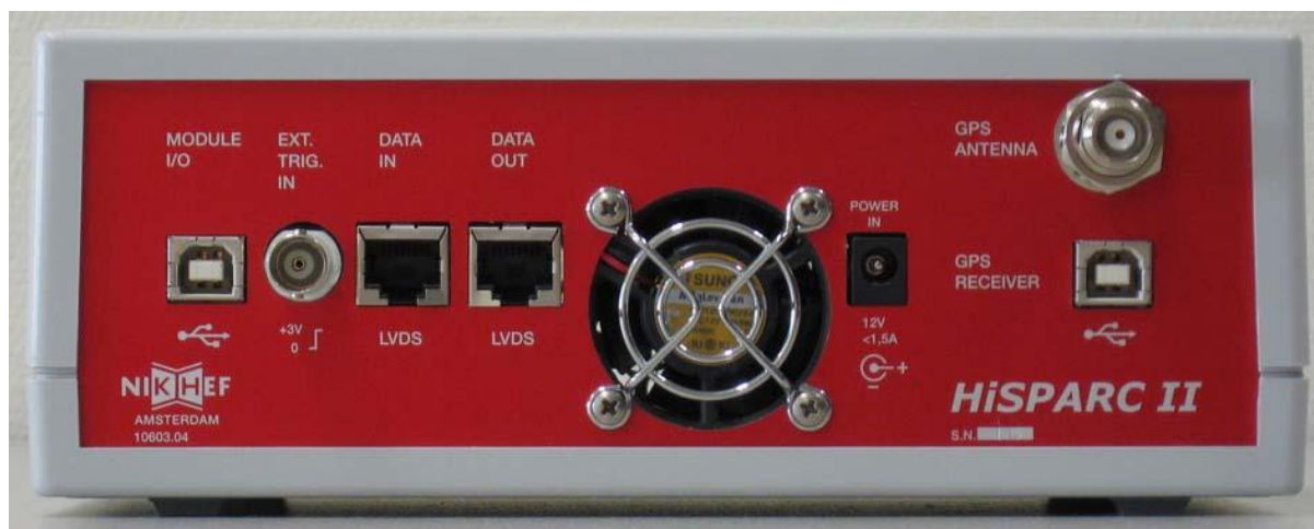
Figure 2.2: De achterzijde van de HiSPARC II Master; van links naar rechts: USB aansluiting voor het versturen van de meetgegevens naar de pc, TTL aansluiting voor een externe trigger (alleen voor speciale doeleinden), twee UTP verbindingen (niet van toepassing), uitgang luchtkoeling, aansluiting voedingsadapter (12 Volt DC, 1.5 A), GPS antenne aansluiting (rechtsboven) en USB verbinding voor het aanpassen van de GPS instellingen.
